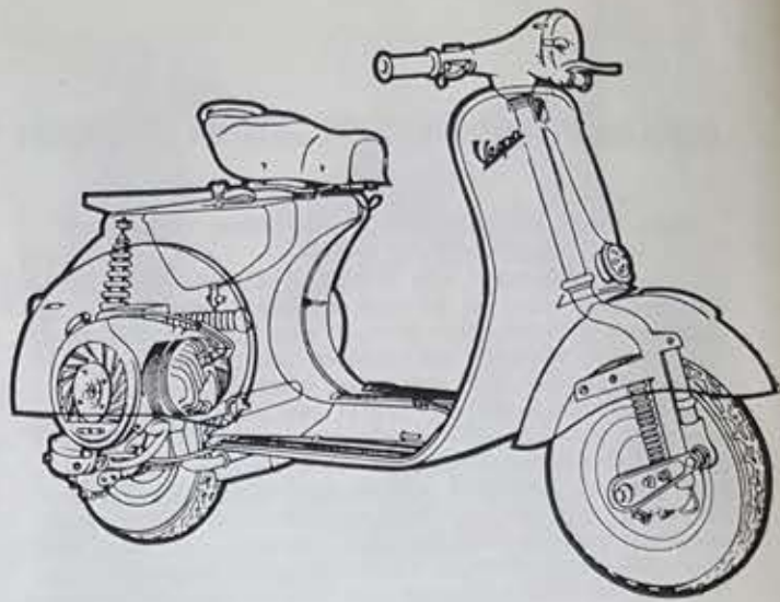
Een duidelijk overzicht van de opstelling van de belangrijkste organen van de GL 1959.
