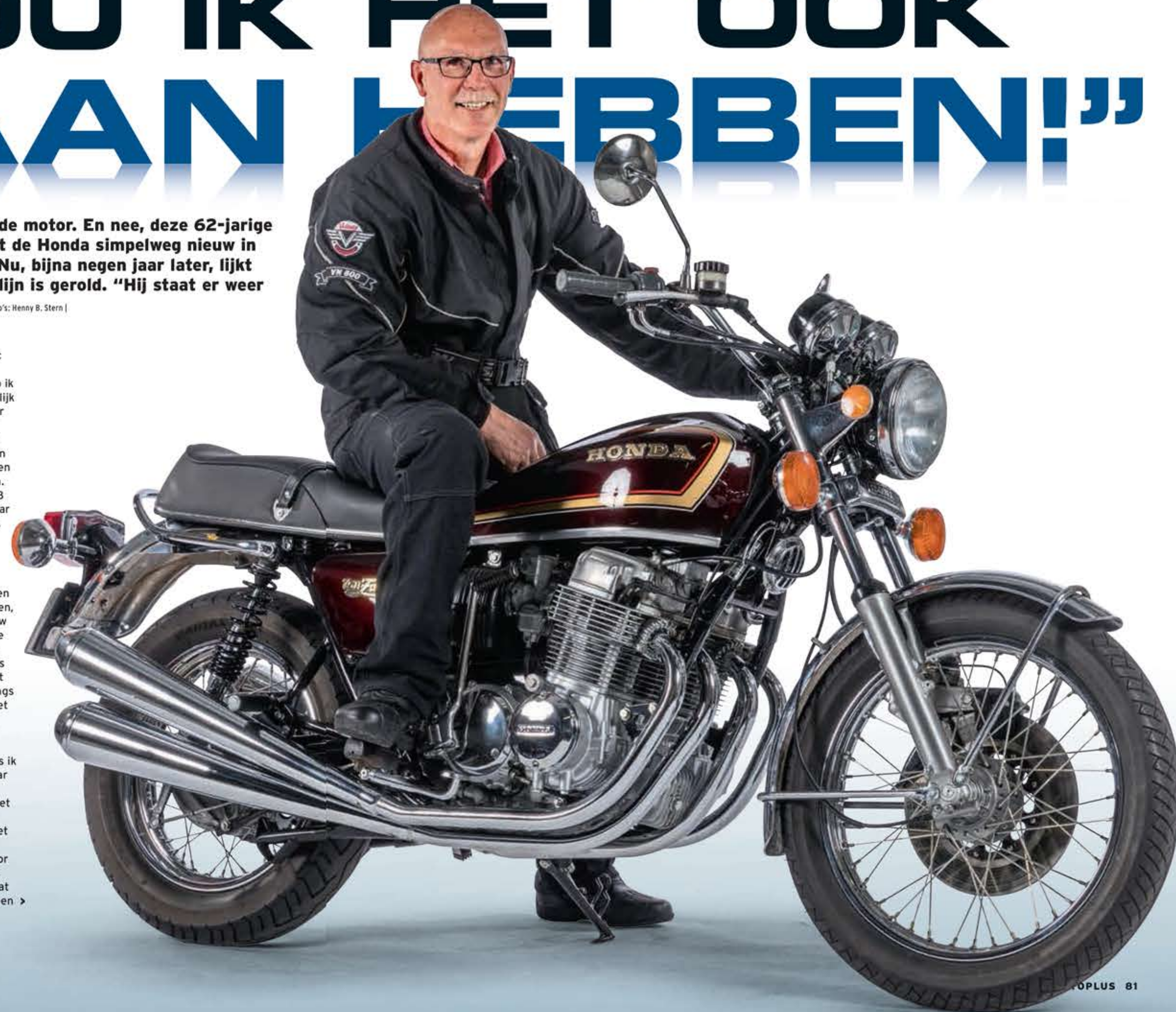
Vier cilinders, vier uitlaten: eenvoudig in z'n meest pure, maar o zo fraaie vorm.
