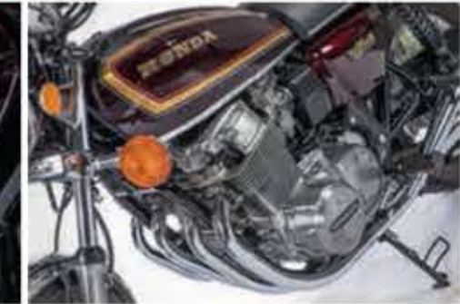
Op een paar nieuwe zuigerveren na werd de vier-in-lijn enkel optisch onder handen genomen.
